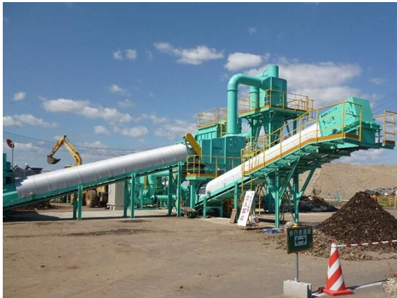
振動・風力による選別施設
