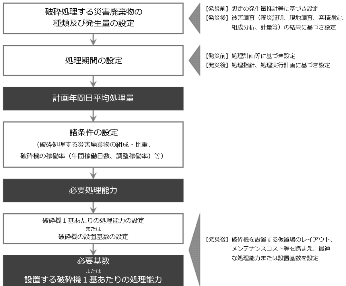
図 2-15 仮設破碎機の必要基数の算定フロー 出典：災害廃棄物対策指針技術資料（環境省 平成 31 年 4 月）
