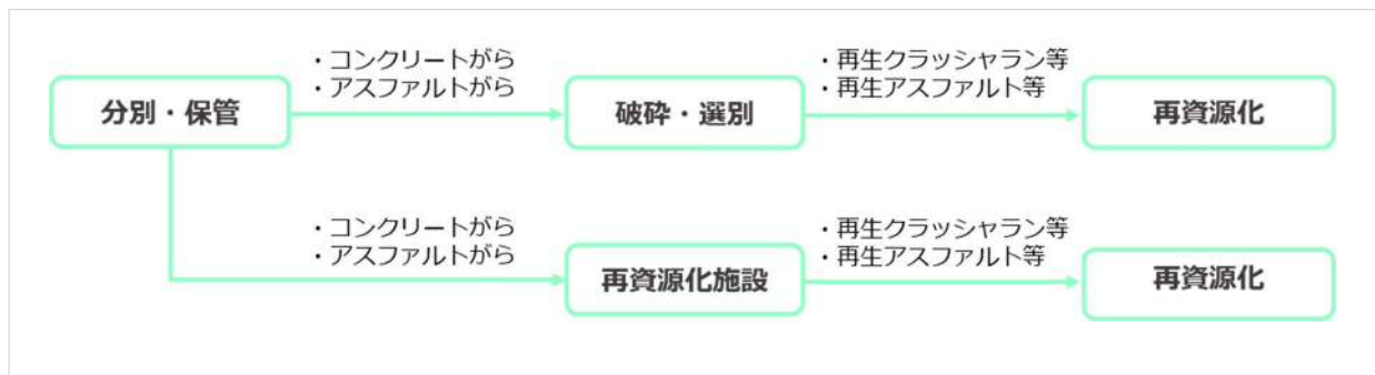
図 2-21 コンクリート・アスファルト系混合物の処理フローの例
