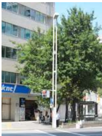
歩行者用信号と道路標識、道路照明灯が統合されることで、すっきりとした景観になっています(名古屋市)
