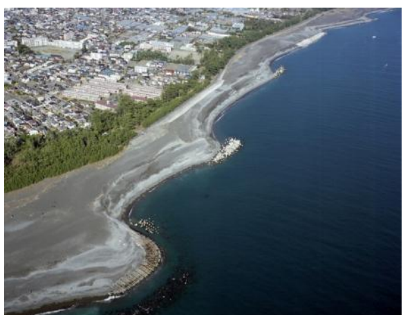
海岸侵食防止のために設置された消波ブロック
