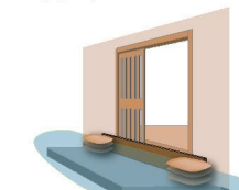
長めの板と土のうで、玄関などから入ってくる水を防げます。
