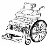
モールド型（車椅子の構造フレーム）
