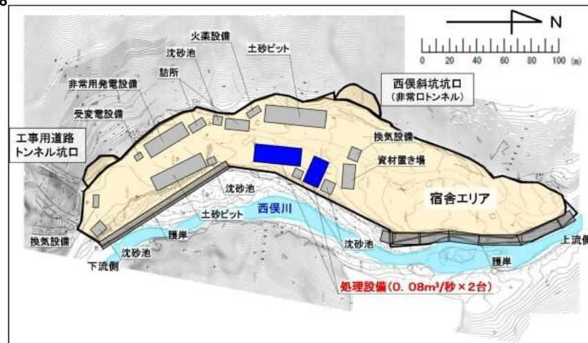
西俣ヤード内での処理設備設置計画 (トンネル掘削開始時)
