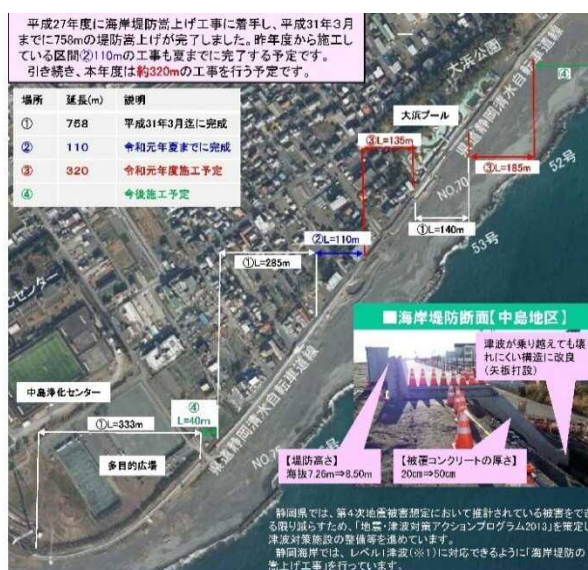
図4 静岡海岸の堤防嵩上げ工事の進捗
