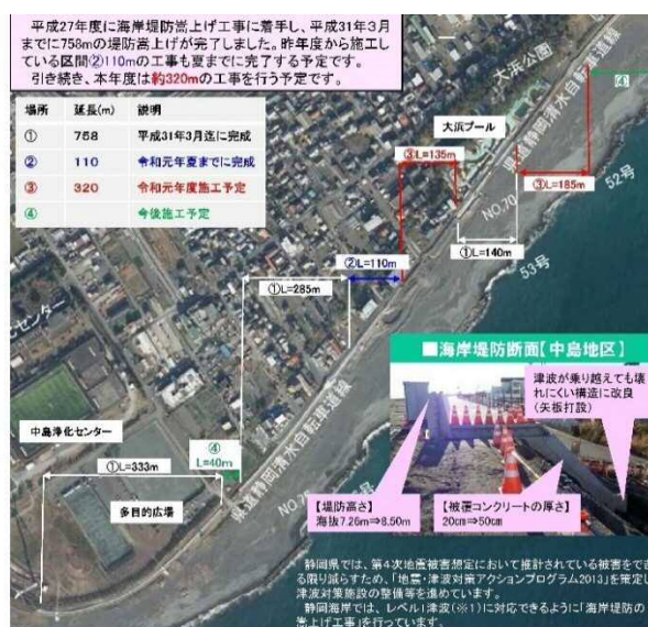
図4 静岡海岸の堤防嵩上げ工事の進捗
