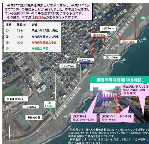
図4 静岡海岸の堤防嵩上げ工事の進捗
