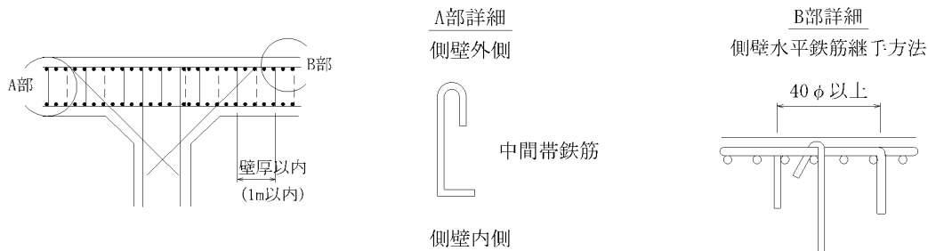
図 5.5-2 側壁水平断面の配筋
