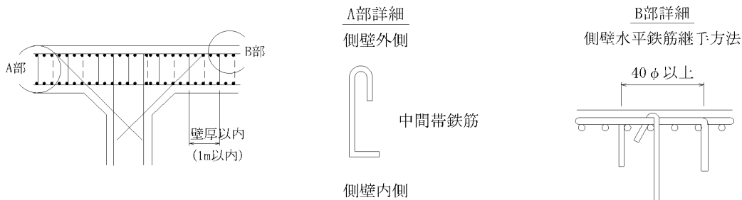
図 5.5-2 側壁水平断面の配筋
