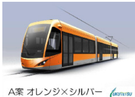
全長:約 27m 定員:155 人(うち座席 53) 福井鉄道が導入する 30m 級車両イメージ
