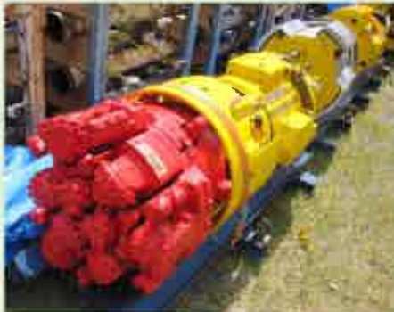
(写真3:推進機(掘削機械))
