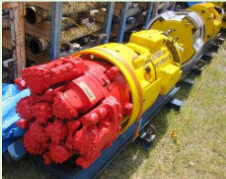
(写真3:推進機(掘削機械))
