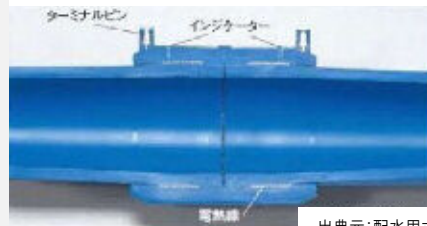
融着接合状況(管断面)
