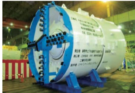
下川原雨水貯留管で使用した掘削マシン
