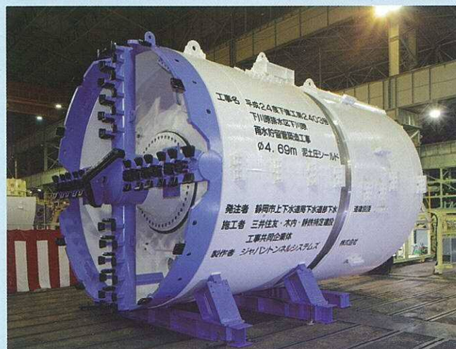
工事で使用したシールドマシン。地中を掘削しながら前進し、後方にセグメントと呼ばれるピースを組み立てることにより、地下にトンネルを構築することができる掘進機。
