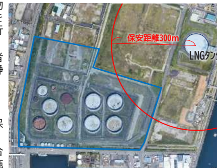
図：既存LNGタンクからの保安距離
