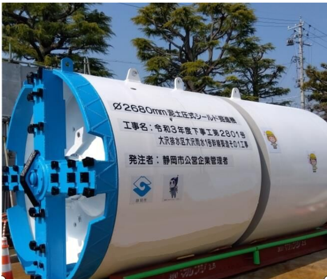
シールドマシン (大沢排水区 浸水対策工事)
