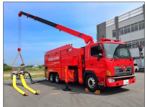
車載の水中ポンプ（写真提供：四日市市消防本部）
