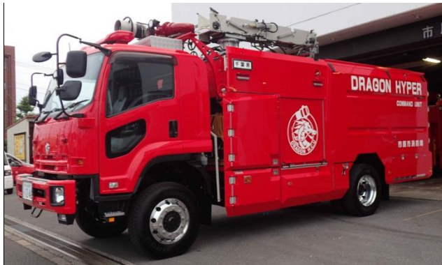
大型放水砲搭載ホース延長車（写真提供：市原市消防局） 大型放水砲による放水（写真提供：四日市市消防本部）
