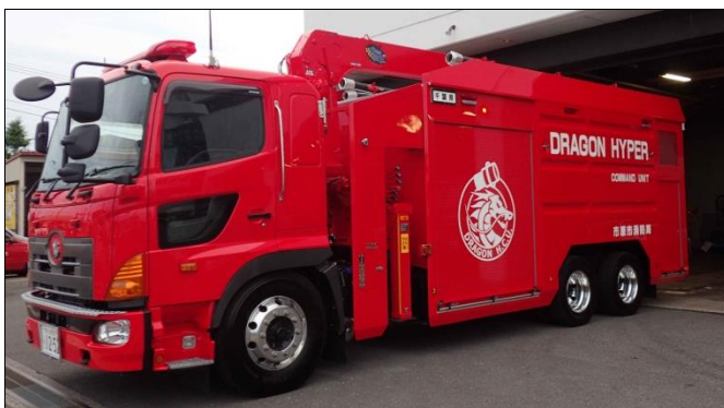
大容量送水ポンプ車（写真提供：市原市消防局）
